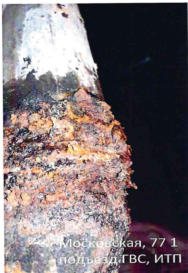
Коррозионные отложения оцинкованного стального трубопровода
